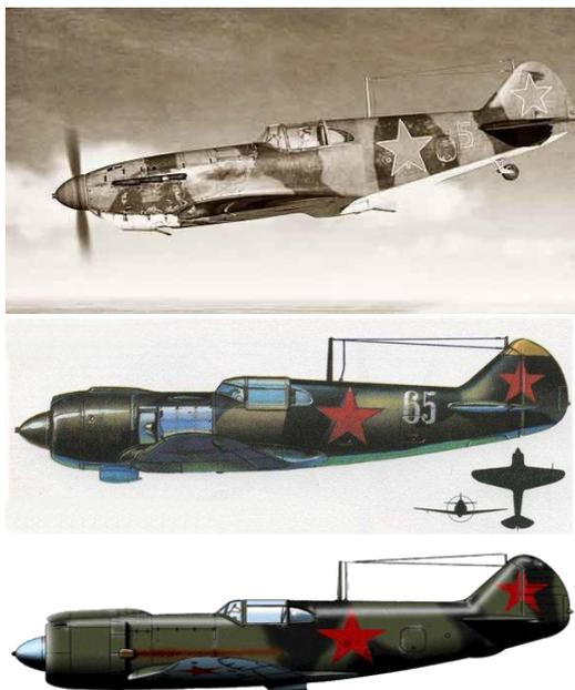
Рис. 8.2-1. Истребители: ЛаГТ-3 (вверху), Ла-5 (посередине), Гу-82 (внизу). Модификации Ла-5Ф и Ла-5ФН выглядели иначе: фюзеляж был изменён в целях улучшения обзора задней полусферы.
