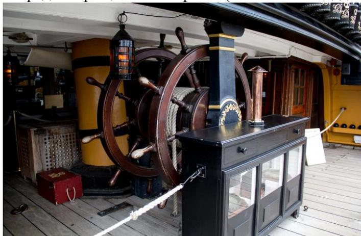
сдвоенные штурвальные колёса (на фотографии слева — сдвоенный штурвал британского линейного корабля-музея «Victory» — флагмана Нельсона в Трафальгарском сражении; на продольном разрезе шлюпа «Восток» на рис. 8.3-1 также показан сдвоенный штурвал — он и компас размещены в нос от бизань-мачты), и в сильные шторма управление рулём осуществляли рулевые в удвоенном, а то и в утроенном количестве: уход с курса в шторм мог
