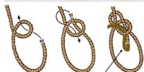
Ответ на этот вопрос простой — научитесь вязать беседочный узел (№ 16 на рисунке выше): он держит крепко, не затягивается под нагрузкой, легко распускается, когда в нём отпала надобность. На рисунке слева он же представлен в двух вариантах, вариант 2 с петлёй, на которую указывает стрелка, предназначен именно для того, чтобы его можно было легко и просто развязать.
