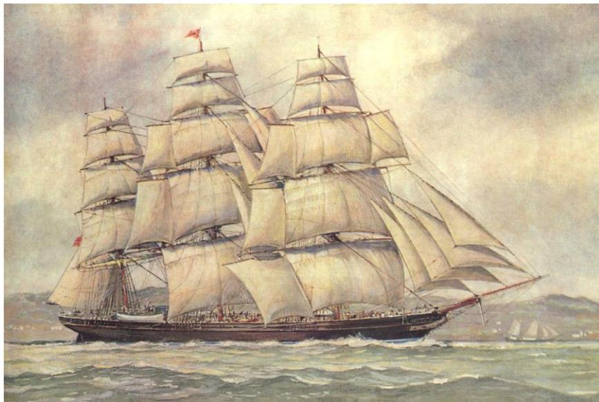
Рис. 8.3-3. Клипер «Sovereign of the Seas» («Повелитель морей») под всеми парусами, включая дополнительные (лиселя). Построен в США в 1852 г., водоизмещение 2421 т, длина по ватерлинии 76,8 м.
