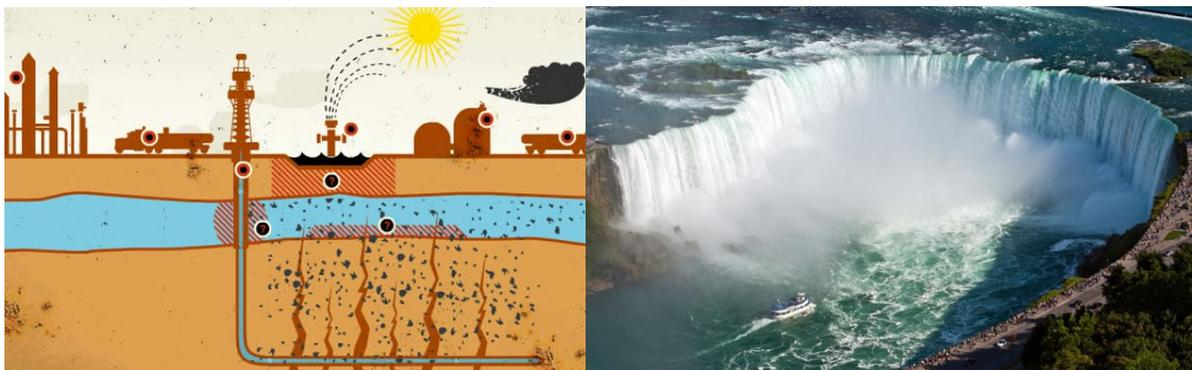
[Принцип загрязнения](#) водоносных пластов и грунтовых вод высокотоксичной «химией», применяемой при добыче сланцевого газа и нефти. В докладе ЕРА (декабрь 2012) на [сс. 62-69](#) в графическом виде изображены и другие сценарии миграции веществ из зоны ГРП в вышележащие пласты, включая водоносные. Справа: [Ниагарский водопад](#), дающий визуальное представление об объёмах воды, используемой при ГРП.
