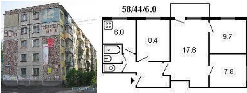
Рис. 9.3-9. Дом серии 1-335А-2 и план 4-комнатной квартиры в нём. Они размещались в торцах здания со стороны, противоположной подъездам. На плане квартира противоположного торца.
